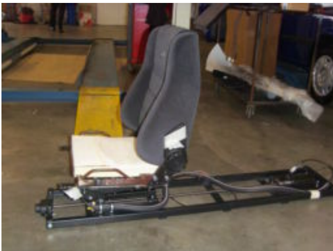
Bestuurdersstoel op rails op maat maken
